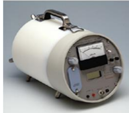
Hình 3. Thiết bị Aloka TPS - 451C Đo suất liều neutron phát ra từ các máy gia tốc, nguồn neutron v.v... sử dụng đầu dò He-3
