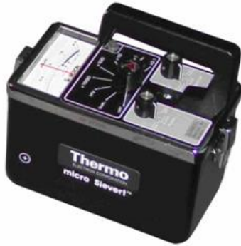
Hình 2. Thiết bị Micro Sievert Meter Đo suất liều Gamma và tia X sử dụng đầu dò nhấp nháy
