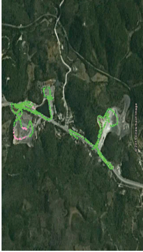
Phân bố không gian các giá trị suất liều bức xạ gamma đo được tại khu vực cửa khẩu Hữu Nghị trên nền ảnh vệ tinh
