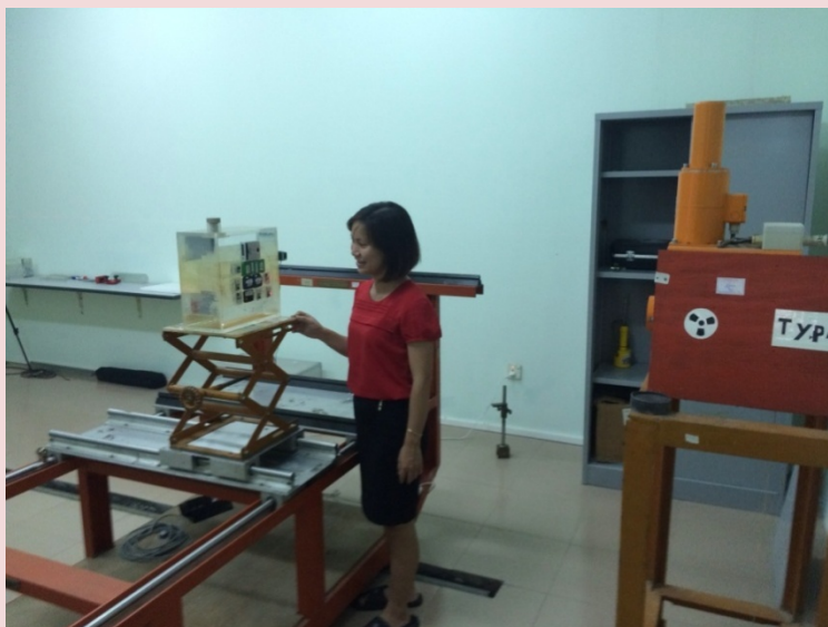
Cán bộ Phòng Cấp phép thực hiện chiếu liều kế tại Phòng chuẩn liều
