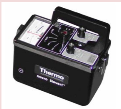
Hình 2. Thiết bị Micro Sievert Meter Đo suất liều Gamma và tia X sử dụng đầu dò hấp nháy
