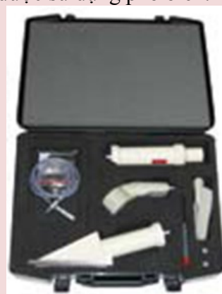
Thiết bị Radiagem-2000 Đo suất liều tia bức xạ Gamma, tia X; đánh giá nhiễm bẩn bề mặt bằng các phép đo tổng Alpha và Beta
