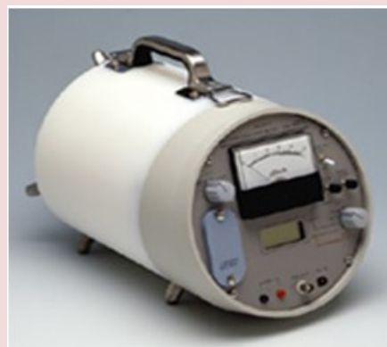
Hình 3. Thiết bị Aloka TPS - 451C Đo suất liều neutron phát ra từ các máy gia tốc, nguồn neutron v.v... sử dụng đầu dò He-3
